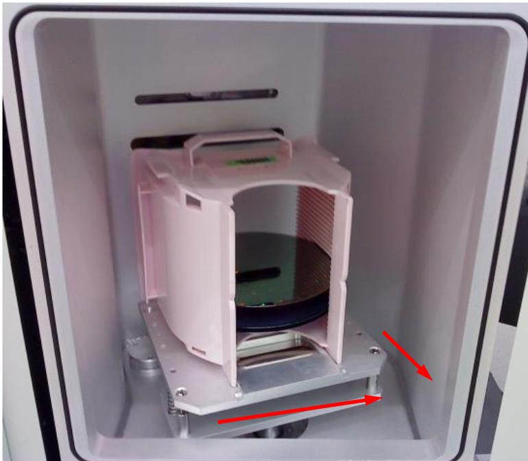
P1 : Load-lock B 放置方法(往外往後輕推),Load-lock A 則與 Load-lock B 相反方向放置.
