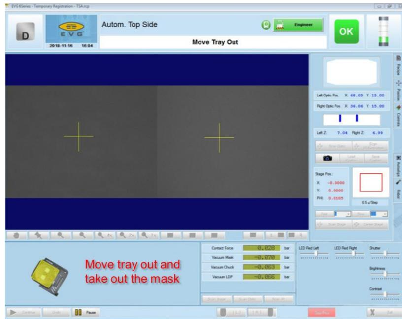
27. End Of Process-Press <Continue> Or <Exit>步驟，如要更換光罩以相同 recipe 曝光，按 **Continue** 鍵，回到步驟 5。結束曝光按 **Exit** 鍵，回到步驟 4 的 Recipe 分頁畫面。
