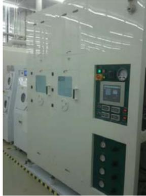
圖一、8吋後段化學清洗蝕刻工作站
