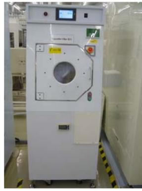
圖二、8吋晶圓乾燥用旋乾機。
