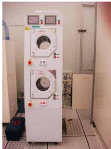
(圖二)晶圓乾燥用旋乾機。
